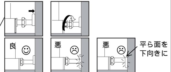
下部 c を間口に合わせて引出し、平らな面が下向きになるよう取付、ナットを締め付けます
